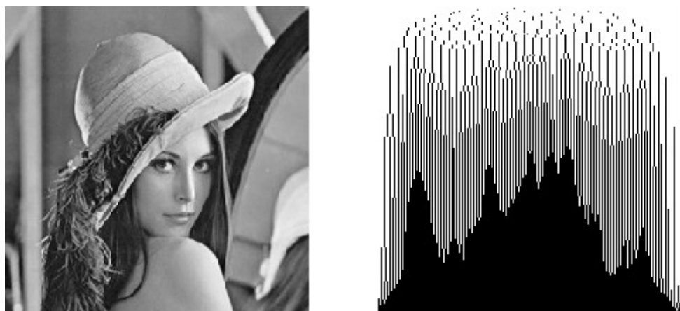
Рис. 1. Стандартное изображение (слева) и квадратная матрица оптимальных разбиений на диапазоны (справа), в строках которой правые граничные бины гистограммы каждого диапазона помечены черным цветом.
